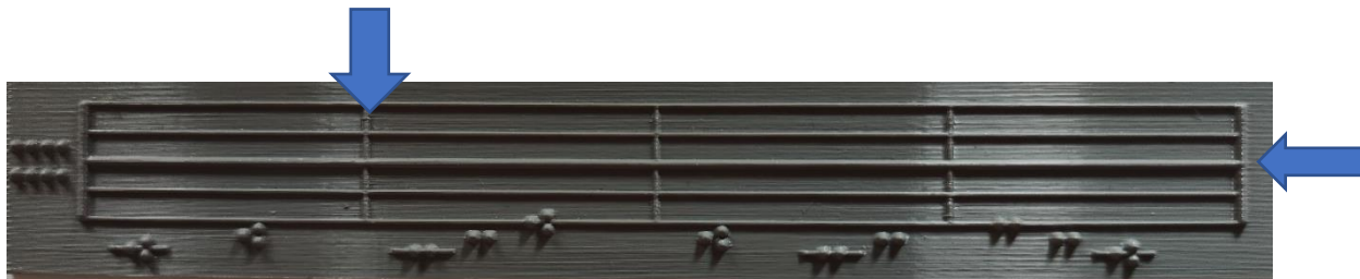
Rys. 5. Przykład zapisu wysokości nut 3D na pięciolinii. Strzałkami oznaczono kreskę taktową i środkową linię pięciolinii
