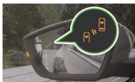
Lampka kontrolna systemu BSD z lewej strony
